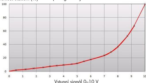
Vstupní signál je prímo úmerný účinnosti rotoru, čož značí, že vstupní signál a otáčky jsou podle pripojeného diagraamu.
